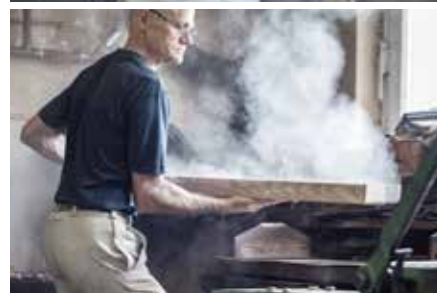
Die auf exakte Länge zugeschnittenen Holzteile werden, je nach Querschnitt, mehr oder weniger lang gedämpft. Anschliessend werden die Hölzer durch das Holzbiege-werk K. Winkler AG in Felsenau (CH) nach dem bewährten Bugholzverfahren gebogen.
