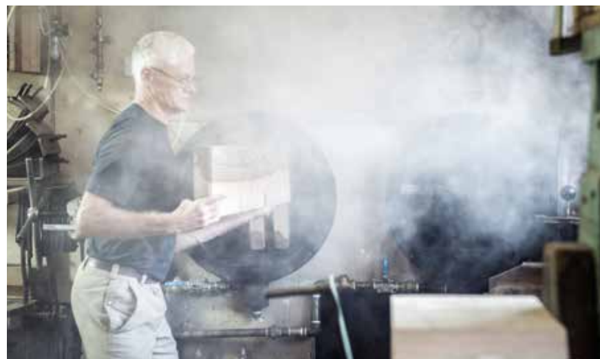
Die auf exakte Länge zugeschnittenen Holzteile werden, je nach Querschnitt, mehr oder weniger lang gedämpft. Anschliessend werden die Hölzer durch das Holzbiege-werk K. Winkler AG in Felsenau (CH) nach dem bewährten Bugholzverfahren gebogen.
